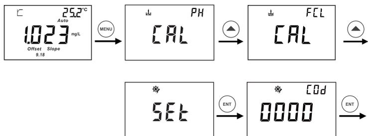
如上圖所示，在測量模式下按 **MENU** 鍵進入設定畫面，然後按 **▲** 鍵可選擇進入對PH、餘氯的校準，或進入餘氯的設定，並按 **ENT** 鍵畫面提示輸入密碼，用 **▲** 鍵和 **▶** 鍵輸入正確的密碼，按 **ENT** 鍵進入設定流程。具體操作如下：
