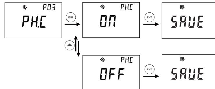
從P-03pH補償設定介面中按 **(ENT)** 鍵進入，按 **(▲)** 鍵可選ON（開啟pH補償）或OFF（關閉pH補償），最後按 **(ENT)** 鍵確認設定完成。
