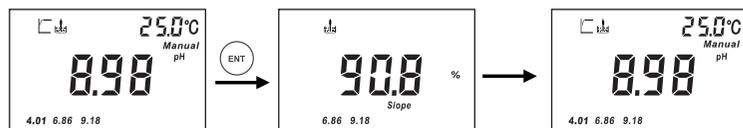
螢幕中電極圖示和2個未校準過的標準值不停閃爍，提示用戶可以校準相應的標準值。將電極放入標準溶液中，待資料穩定後按 **(ENT)** 鍵確認，儀表會顯示電極斜率畫面。然後進入下一個校準迴圈進行第3點校準，步驟如下：
