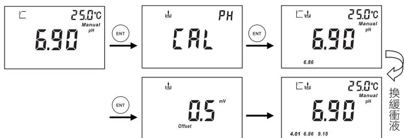
如上圖所示；在測量模式按 **(MENU)** 鍵即可進入pH校準提示畫面，按 **(ENT)** 鍵確認進入校準流程。將電極放入標準溶液中待資料穩定後按 **(ENT)** 鍵確認。螢幕會顯示偏移量Offset畫面。
